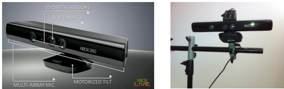
Figura 7. Detalle de una de cámara Kinect y de su colocación.
